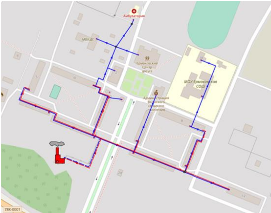
Рисунок 6. Зона действия котельной «Ермаково», п. Ермаково
